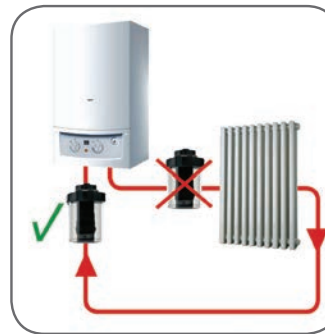
Fig. 6 - Corretta installazione di MAG-NEX HP
