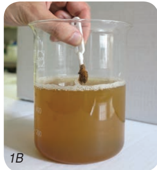
Fig. 1A, 1B e 1C – Alcuni esempi di acqua d'impianto rispettivamente non corrosiva, corrosiva e molto corrosiva ricca di magnetite
