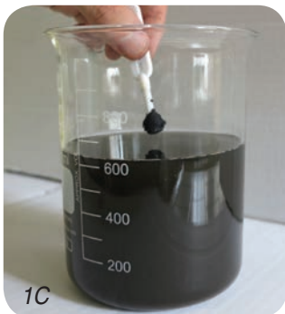
Fig. 1A, 1B e 1C – Alcuni esempi di acqua d'impianto rispettivamente non corrosiva, corrosiva e molto corrosiva ricca di magnetite
